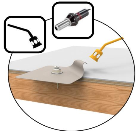
Sobald die Dachkonsole in die vorge-sehene Position gebracht wurde, kann sie mit ihren Seitenkanten fachgerecht ausgerichtet werden.
