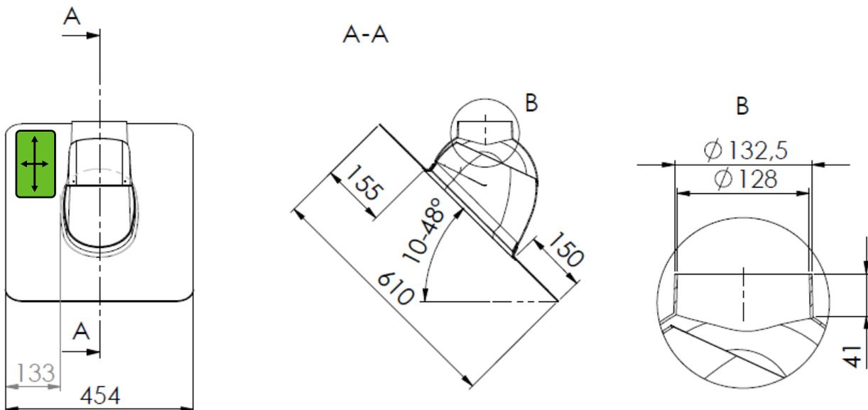
! Bei der Installation ist es wichtig, die Richtung des FastFlashes zu berücksichtigen, damit das Formen gegen die Oberfläche von beispielsweise Eternit oder Ziegel angemessen und ohne Risiko einer Beschädigung des Eindringens durchgeführt wird.
