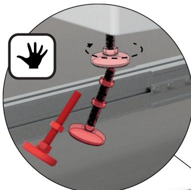
Als erster Schritt werden alle 4 Aufstellfüße von der Wärmepumpe entfernt.
