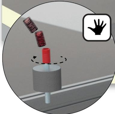
Die Gewindebuchse (M8/M12) wird vor der Montage an der Wärmepumpe auf den Gummidämpfer montiert.
