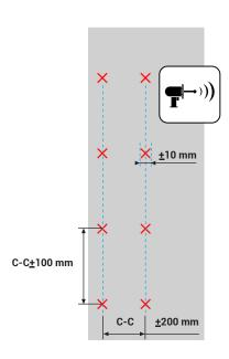
Die obige Abbildung zeigt die allgemein zulässigen Toleranzen für die Positionierung von Dachkonsolen. Wenn größere Abweichungen erforderlich sind, sollte FIXNORDIC kontaktiert werden.
