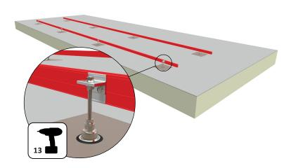
Die Montage der gesammelten Tragschienen erfolgt auf die gleiche Weise wie die Montage der Tragschienen - d.h. mit den vormontierten Hammerkopfschrauben zur Sicherung der Montage. Auch hier ist es sehr wichtig, auf die Ausrichtung der Hammerkopfschrauben zu achten.
