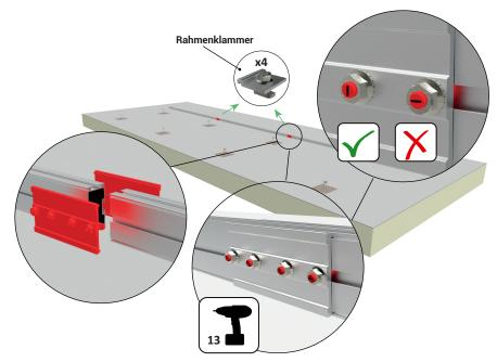
Diese Abbildung zeigt, wie die beiden Schienenverbinder in jedem Profilmontagepunkt positioniert werden. Drehen Sie die Hammerkopfschrauben beim Anziehen um 90°, um die richtige Festigkeit der Verbindung zu gewährleisten. Bitte beachten Sie, dass jede Schraube am Ende eine Markierung hat, die die Position der Hammerkopfschraube angibt.
