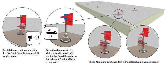
Vor der Montage der Fix Point Beschlägen muss die Höhe des Moduls bestimmt werden. Normalerweise wird dazu der höchste Punkt auf der Dachfläche ermittelt, der den Mindestabstand zwischen dem Modul und der Dachfläche definiert.
