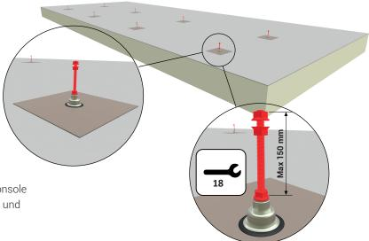
Der Stiftbolzen wird in das M12 Innengewinde jeder Dachkonsole eingesetzt. Er sollte etwa 20 mm in das Gewinde eingeführt und dann mit einer Kontermutter gesichert werden.
